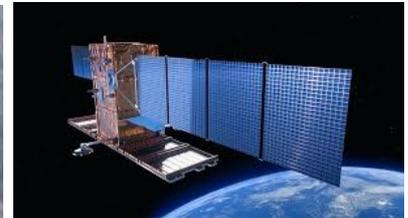
**Les 5 satellites SAR-Lupe** de 775 Kg sont sur 3 plans héliosynchrone décalé de 65°, offre une résolution de 1 mètre *sont lancés par Cosmos 3 Plessetsk-Russie.*
